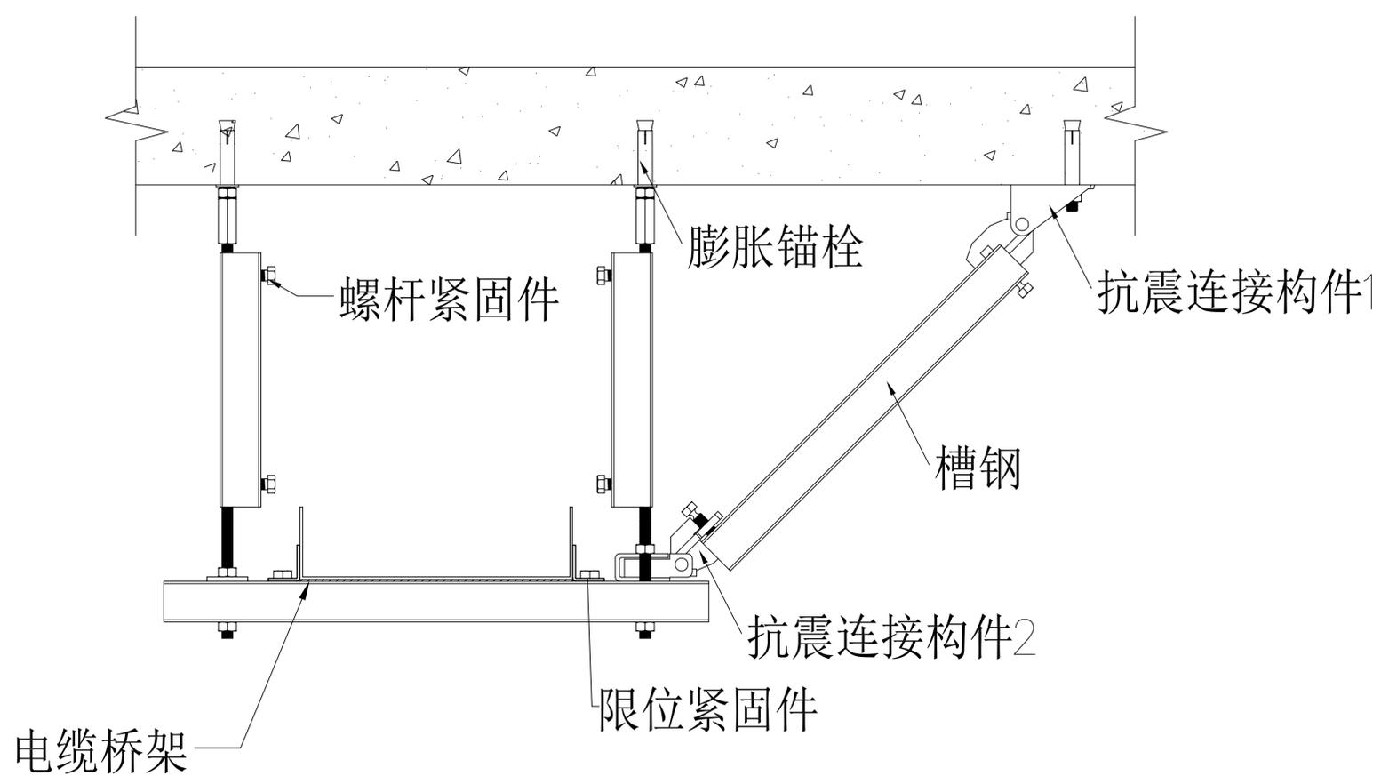
电缆桥架侧向抗震基础方案A
