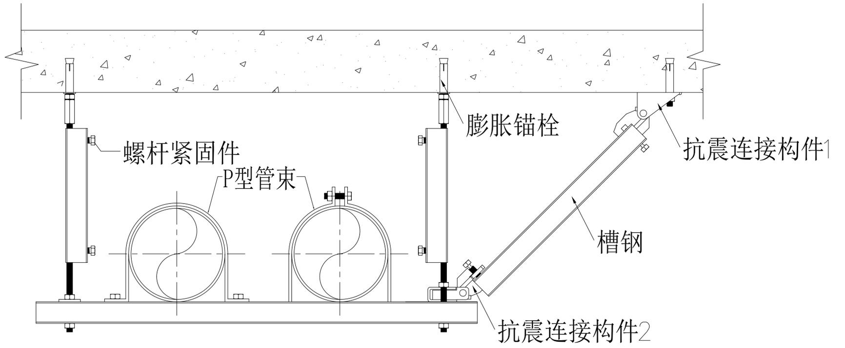
多管共架侧向抗震基础方案A
